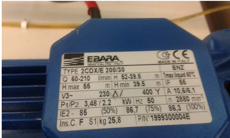
Figura 7. Características técnicas de las bombas.
